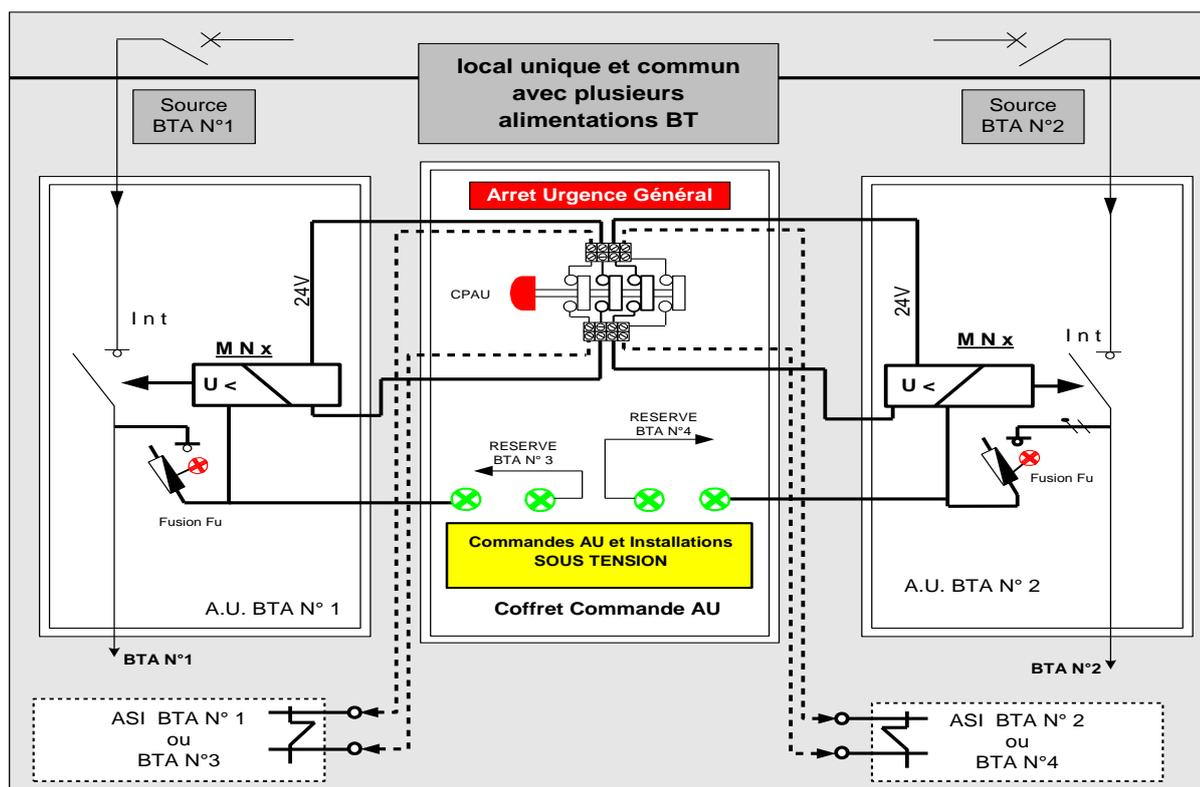
Schéma de principe du CPAU (bobine MX 230v) :
