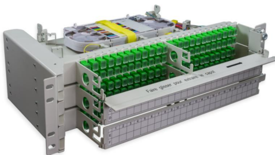
Exemple de tiroir de capacité 144FO (3 modules de 48)
